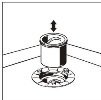
6) Das Tauchrohr in den Geruchsverschluss einsetzen.
