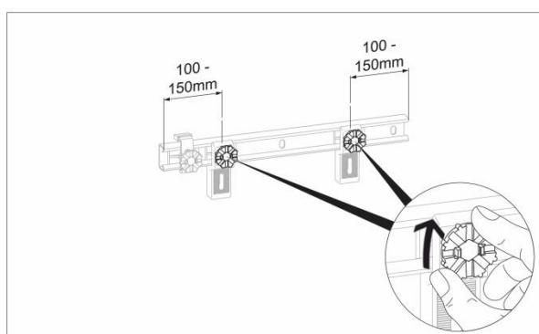
4) Fixieren Sie die Anker an der Schiene.
