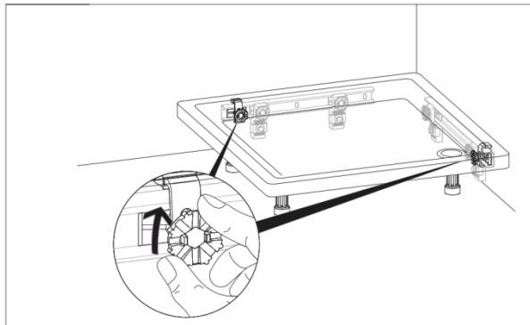
9) Bringen Sie die gezeigten Bauteile auf der Schiene an.
