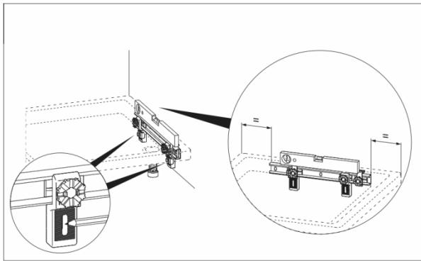
5) Markieren Sie die Bohrlöcher an der Wand. Überprüfen Sie auch die Waagerechte.
