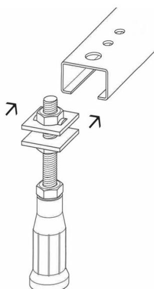
5) Führen Sie den Fuß in die Schiene ein. Beachten Sie, dass eine Stahlplatte innerhalb und eine außerhalb der Schiene verbleibt.
