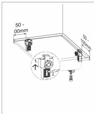
2) Positionieren Sie die Anker, je nach Wannentyp, 50-100 mm von der Wannenecke entfernt, an der Wand. Markieren Sie ebenso die Bohrlöcher an der Wand.
