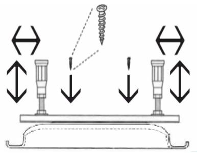
6) Befestigen Sie die Schiene am Boden der Badewanne mithilfe der beiliegenden selbstschneidenden Schrauben.
