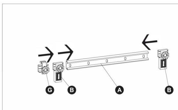
3) Bringen Sie die gezeigten Bauteile auf der Schiene an.
