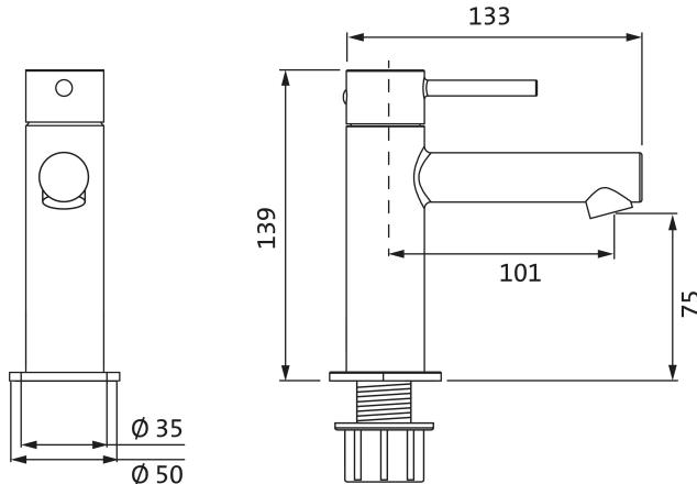
Lochbohrung  $\varnothing$  35 mm
