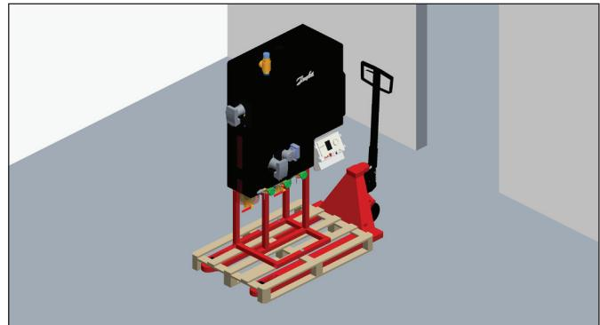
Danach lösen die Anlage von der Palette; hier ist diese mittels 2 Holzschauben fixiert.
