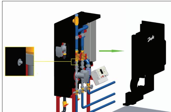
Auch können Sie am Regulierventil (Taco-Setter) den Durchfluss der Zirkulation kontrollieren und/oder regulieren wie im Bild rechts dargestellt:
