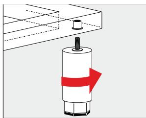
Richten Sie die Anlage mittels Höhenverstellung der Füße horizontal waagerecht, z.B. mittels Wasserwaage, aus.
