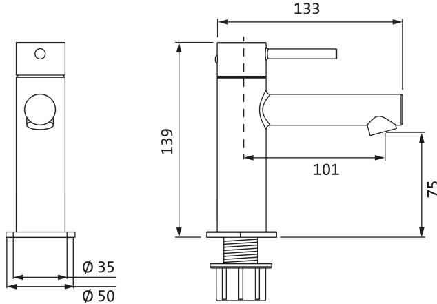
Lochbohrung  $\varnothing$  35 mm
