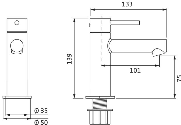
Lochbohrung Ø 35 mm
