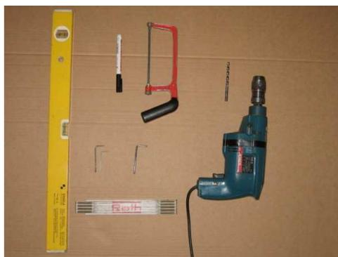
Schlagbohrmaschine mit Steinbohrer
