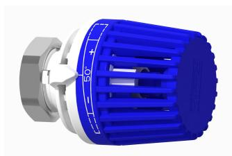
Zusätzlich wird durch die Konstruktion des Reglers eine kontinuierliche Durchströmung im Wärmetauscher und eine damit verbundene Temperaturvorhaltung realisiert. Der Warmwassereinstellbereich am Regler liegt ca. bei 45-55 °C, empfohlene Mindesteinstellung 50°. Zum Schutz vor Verbrühungen kann durch einen Arretierungsring am Regler die Warmwassertemperatur auf einen festen, maximalen oder minimalen Wert begrenzt werden.
