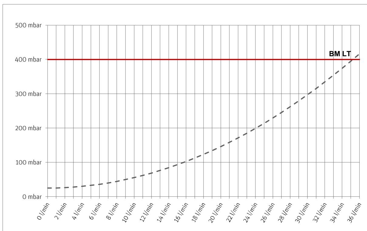
**■ Druckverlustdiagramm Heizung primär** (ohne Zähleinrichtung)
