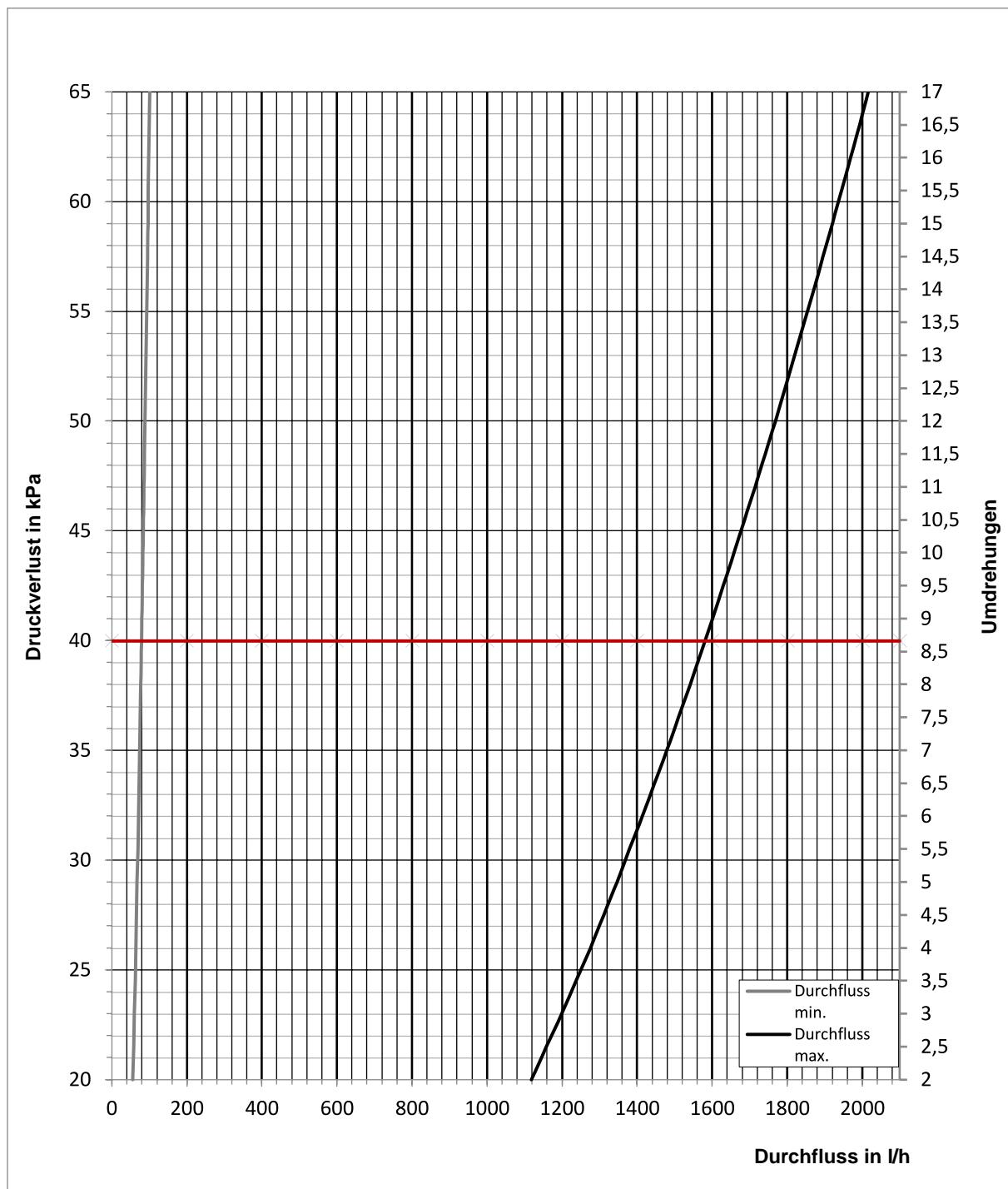
Der Differenzdruckregler Heizung ist werkseitig auf 40 kPa voreingestellt. Um den Regler entsprechend dem Rohrnetz einzustellen benötigt man einen 4 mm Innensechskantschlüssel. Der Schlüssel muss am Regler gegen den Uhrzeigersinn bis zum Endpunkt gedreht werden, sodass die Feder völlig entspannt ist. Im Anschluss muss dieser entsprechend dem entnommenen Tabellenwert (2 bis 17 Umdrehungen) im Uhrzeigersinn eingestellt werden.
