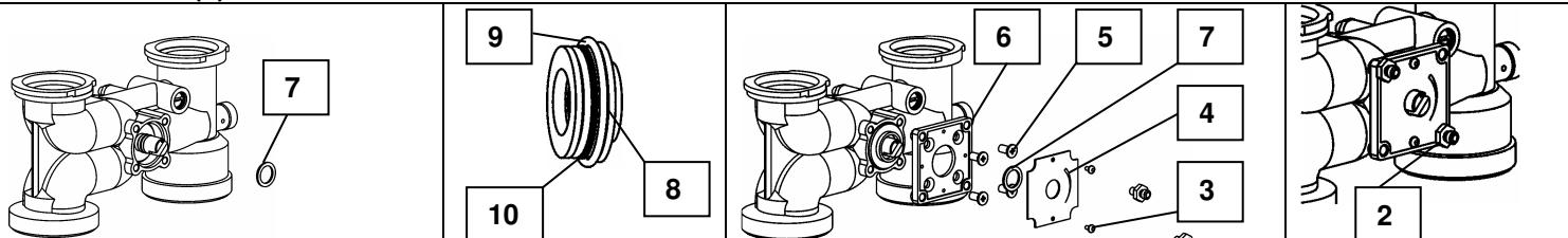
Das Kunststoffteil (8) mit den O-Ringen voran über den Zapfen des Drehschiebers schieben und bis zum Anschlag eindrücken.
