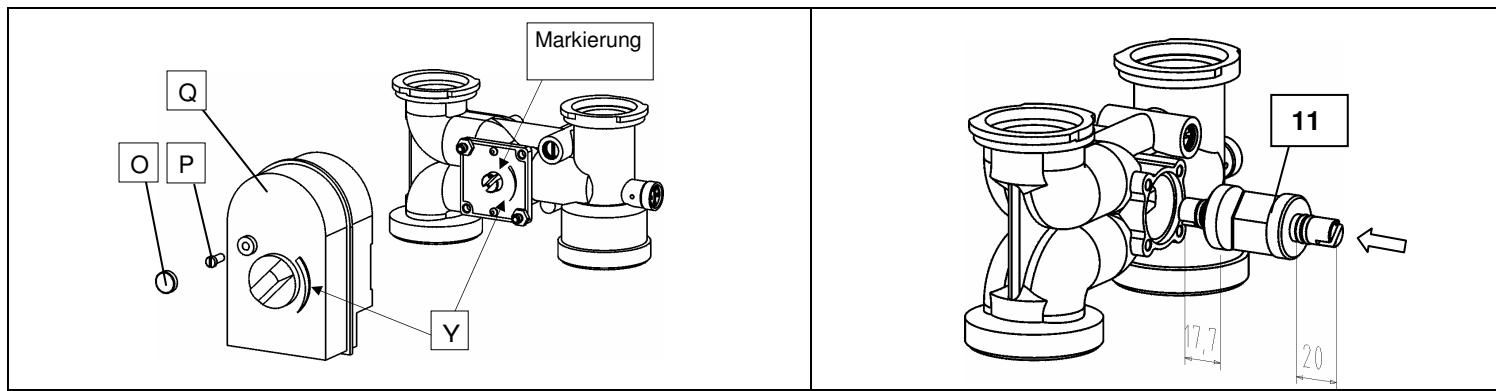
Nach dem Entfernen der Schutzkappe (O) ist eine Sicherungsschraube (P) zugänglich. Nach dem Lösen der Schraube kann der Stellmotor (Q) abgenommen werden.
