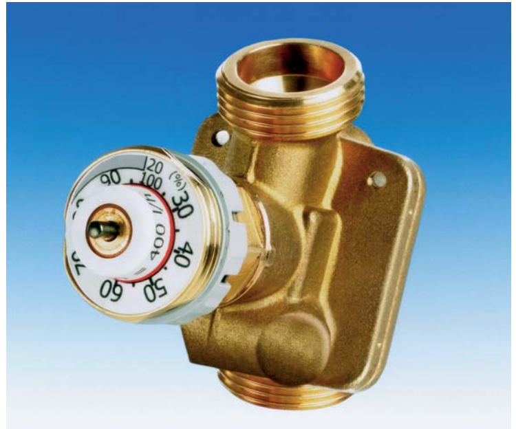
Bild 1 • Das AB-QM von Danfoss kombiniert ein Regelventil mit einem automatischen Ventil für den hydraulischen Abgleich in einem Gehäuse.
