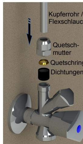
Kupferrohr / Flexschlauch bis zum Anschlag durch die Quetschverschraubung drücken und mit dem Gabelschlüssel festziehen.
