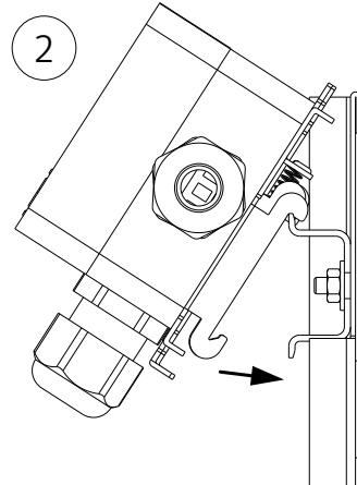
Die Elektroanschlussbox leicht nach vorne kippen und mit der Aufnahme auf die obere Kante der auf dem Modul befestigten Hutschiene aufliegen.
