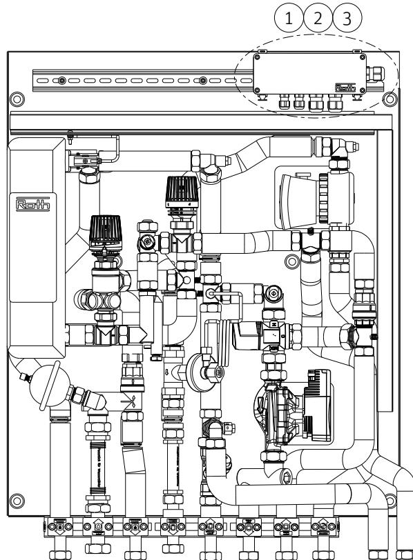
Die federbetätigten Klammern der Hutschienenaufnahme nach Oben drücken.
