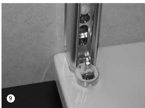
9. Gelenkeinheit und U-Wandausgleichsprofil 8 mm wieder an die Markierung setzen.
