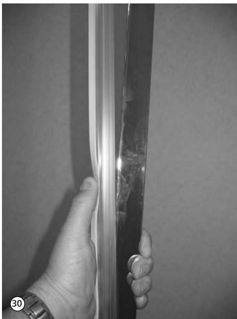
30. Türmagnetdichtung oben auf das 6 mm U-Profil einige Zentimeter aufstecken, somit wird ein Abknicken verhindert. Schrägstehender Magnetstreifen muss zur Außenseite zeigen. Die Türmagnetdichtung wird unten am Profil bündig montiert und auf der gesamten Länge auf das Profil aufgedrückt. Oben muss sie an der Profiloberkante abgeschnitten werden.
