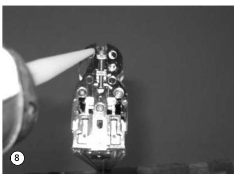
8. Die äußere Hälfte der unteren Gelenkplatte dünn mit Silikon bedecken und darauf achten, dass der mittige Kanal nicht mit Silikon verschlossen wird.
