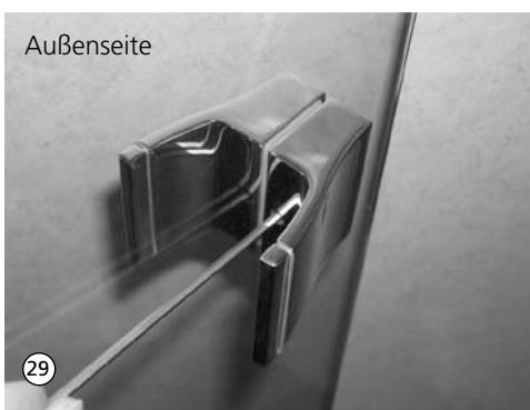
29. Zweite Griffhälfte gemeinsam mit der Griffunterlage von außen über die Befestigungshülse schieben und durch Eindrehen des Gewindestiftes M5 auf Befestigungshülse fixieren. Gewindestift hierbei fest anziehen.
