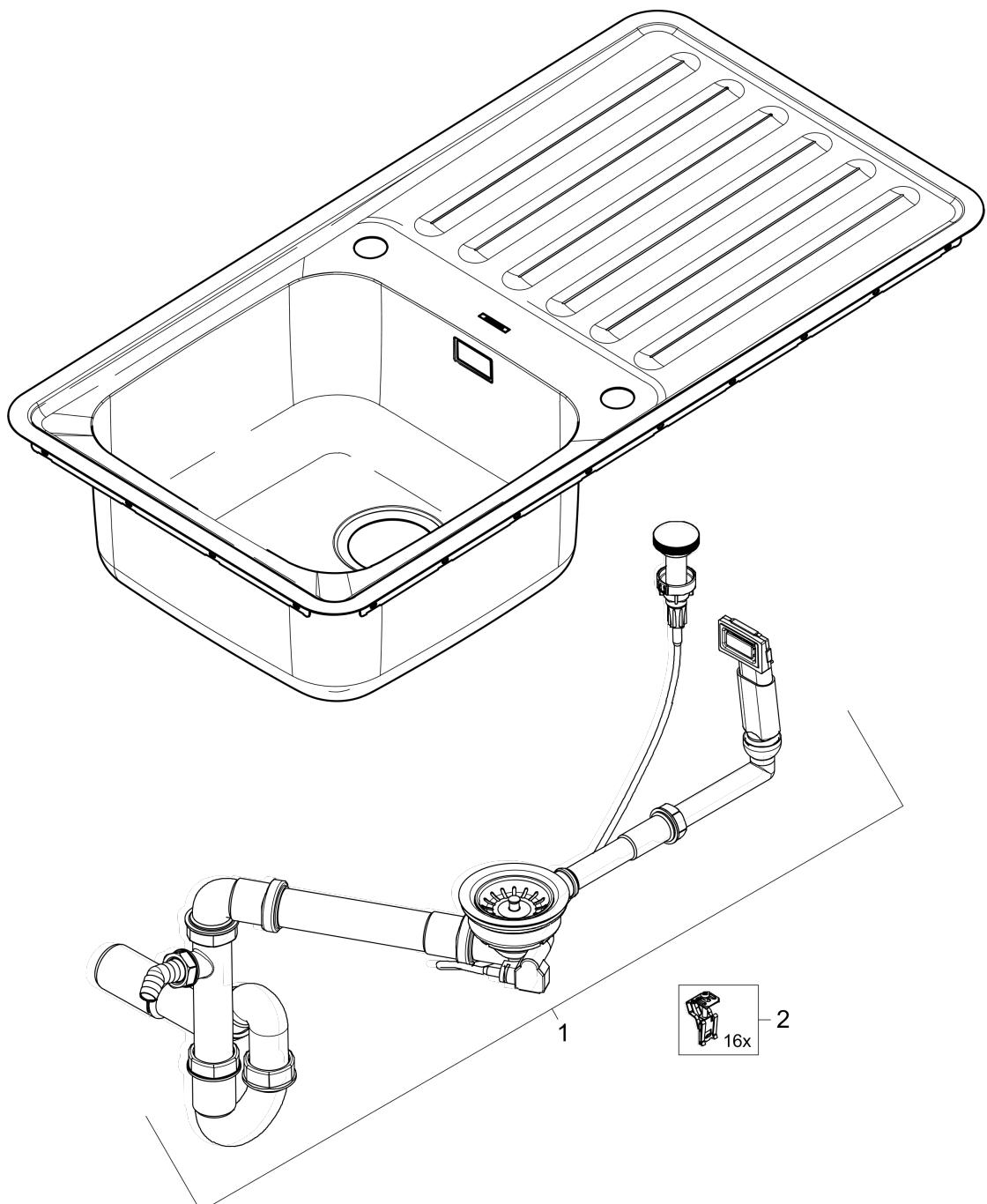
**S41****S4111-F340 Einbauspüle 340 mit Abtropffläche**Oberfläche: **Edelstahl** Artikelnummer: **43340800**
