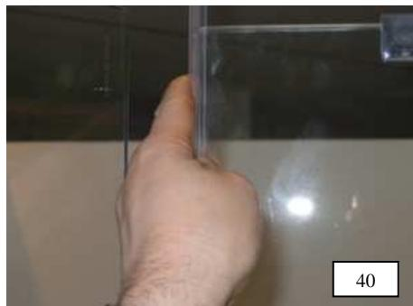
40. Spaltdichtungen oben einige Zentimeter auf die anschlagseitigen Türflügel aufstecken, somit wird ein Abknicken verhindert. Die Ausklinkung muss unten sein. Die Dichtlippe sollte sich innen befinden und am schließseitigen Flügel anliegen können.
