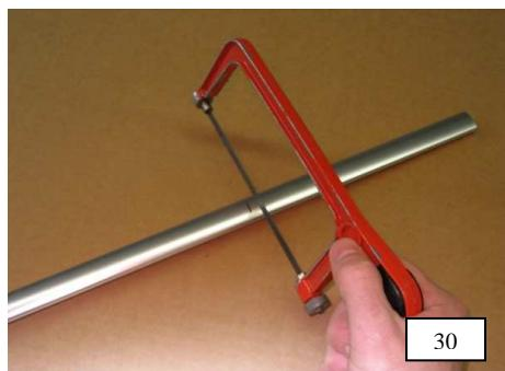
30.Halterohr an gekennzeichneter
