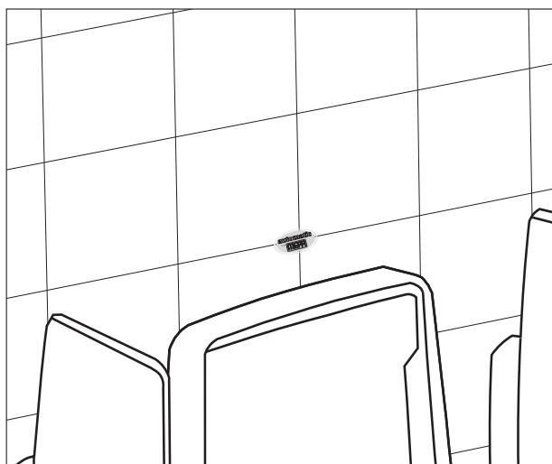
Die erforderliche Spülwassermenge wird über die Spülzeit eingestellt. Sie richtet sich nach dem verwendeten Urinal und dem vorhandenen Wasserdruck.
