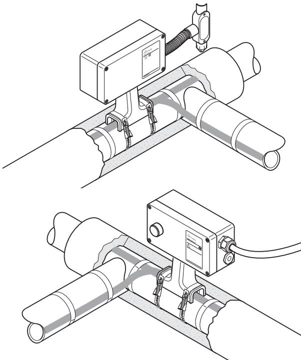
Der Anschlusskasten nVent RAYCHEM JBM-100 ist für den elektrischen Anschluss von bis zu drei Heizbändern des Typs nVent RAYCHEM BTV, QTVR, XTV, KVT, HTV oder VPL geeignet und ist PTB-, FM- sowie CSA-geprüft und für den Einsatz in Ex-Bereichen freigegeben.
