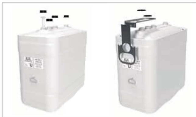
2. Die vier Transportkappen und das Tauchrohr entfernen und die zweiteilige Pumpenhalterung stirnseitig montieren sowie die Stutzenringe auf die ersten beiden Stutzen aufsetzen.
