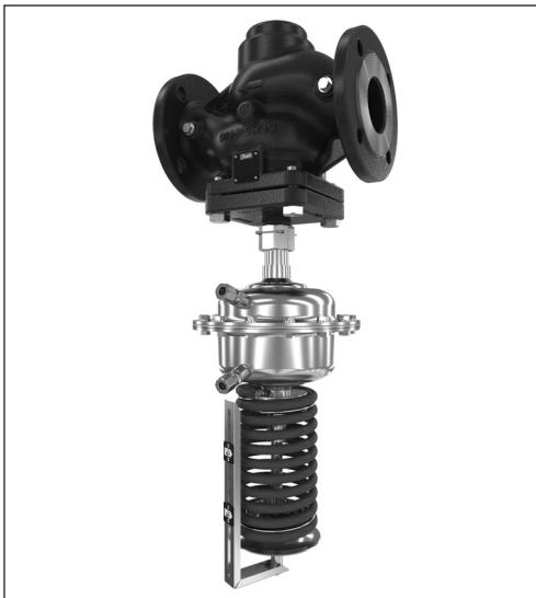
Der AFA 2 / VFG 22(1) ist ein selbsttätiger Überströmregler für den Einsatz überwiegend in Fernwärme- bzw. Fernkältesystemen. Der Regler ist drucklos geschlossen und öffnet bei steigendem Druck.
