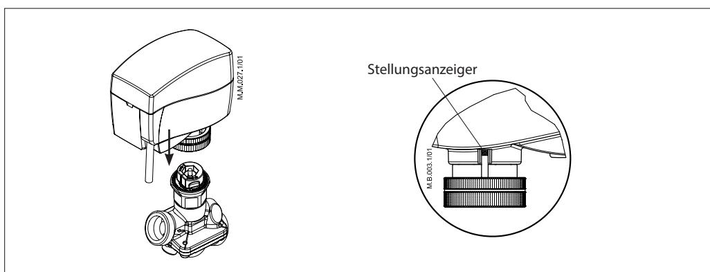
1. Den Ventilhals überprüfen. Die Spindel des Stellantriebs muss sich in der oberen Endlage befinden (Werkseinstellung).
