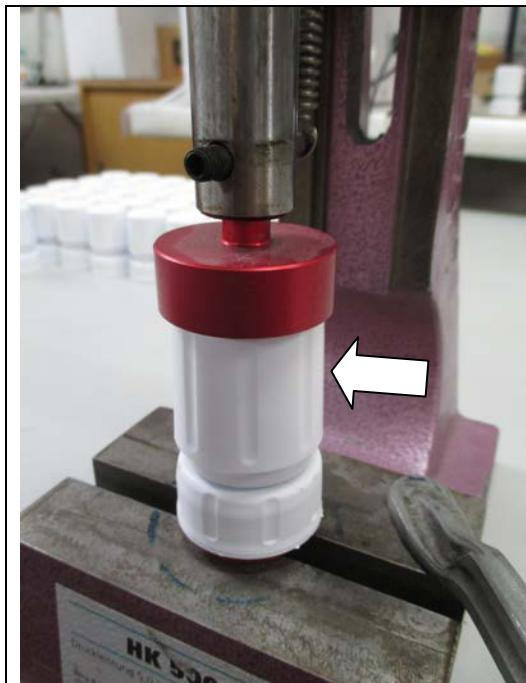
9. Der große Deckel wird über den montierten Belüfter gestülpt und aufgepresst.
