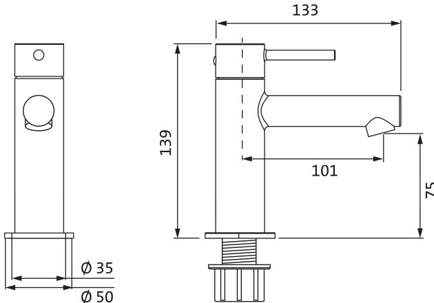
Lochbohrung  $\varnothing$  35 mm
