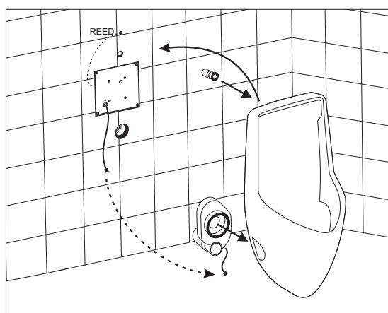
**Hinweis:** Es ist zweckmäßig, den Mepa-Siphon und die Einlaufgarnitur zuerst an der Keramik zu montieren. Keramik nach Herstelleranweisung montieren.
