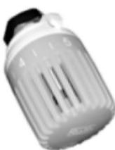
Mit dem Thermischen-Fluid-Regler (TFR) kann eine Warmwassertemperatur zwischen 20 und 70 °C schnell und exakt geregelt werden. Unmittelbar im Warmwasseraustritt des Wärmetauschers befindet sich der zugehörige Temperatur-Wendeführer, der über ein Kapillarrohr mit dem Regler verbunden ist.
