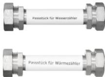
Die Distanzstücke sind aus nahtlos geschweißtem Edelstahlrohr mit Anschlussgewinde. Die Einbaulänge für den Kaltwasserzähler ist 130 mm mit einer Anschlussgröße G 1“ AG. Die Einbaulänge für den Wärmemengenzähler ist 110 mm mit einer Anschlussgröße G 3/4“. Beide Passstücke sind für den Normalbetrieb ohne Einschränkungen zugelassen.
