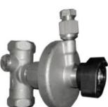
Der Differenzdruckregler Heizung ist zur Durchführung eines hydraulischen Abgleichs. Somit kann die Roth FlatConnect Wohnungsstation fachgerecht in das Anlagen-Rohrnetz eingebunden werden. Der Regler befindet sich im Rücklauf der Heizungsversorgung und ist über ein Kapillarrohr mit dem Vorlauf verbunden. Der einstellbare Differenzdruck befindet sich in einem Arbeitsbereich von 20 bis 65 kPa. Die Voreinstellung ist werkseitig auf 40 kPa eingestellt.
