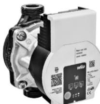
Zur Versorgung der Flächenheizung ist die Umwälzpumpe werkseitig in der Elektro-Anschlussbox auf der Verdrahtungsplatine aufgelegt. Über die Einstellmöglichkeit am Pumpenkopf werden die erforderlichen Versorgungsparameter eingestellt. Diese können wahlweise über Differenzdruck konstant oder variabel mit jeweils 3 Kennlinien oder eine Drehzahlregelung in den Stufen 1 bis 3 geregelt werden.
