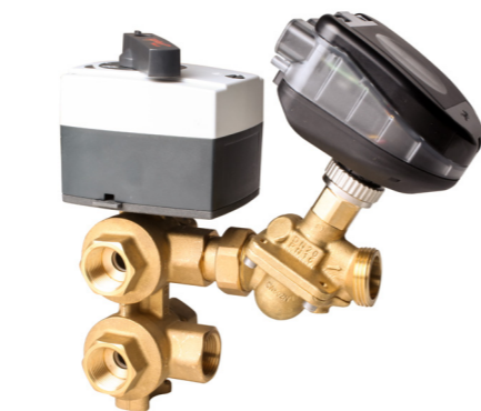
Danfoss NovoCon®, montiert auf AB-QM, regelt sowohl den Durchfluss durch das PICV-Ventil als auch die Position des CO6-Stellantriebs, der auf dem 6-Wege-Umschaltventil für Heizen/Kühlen montiert ist.
