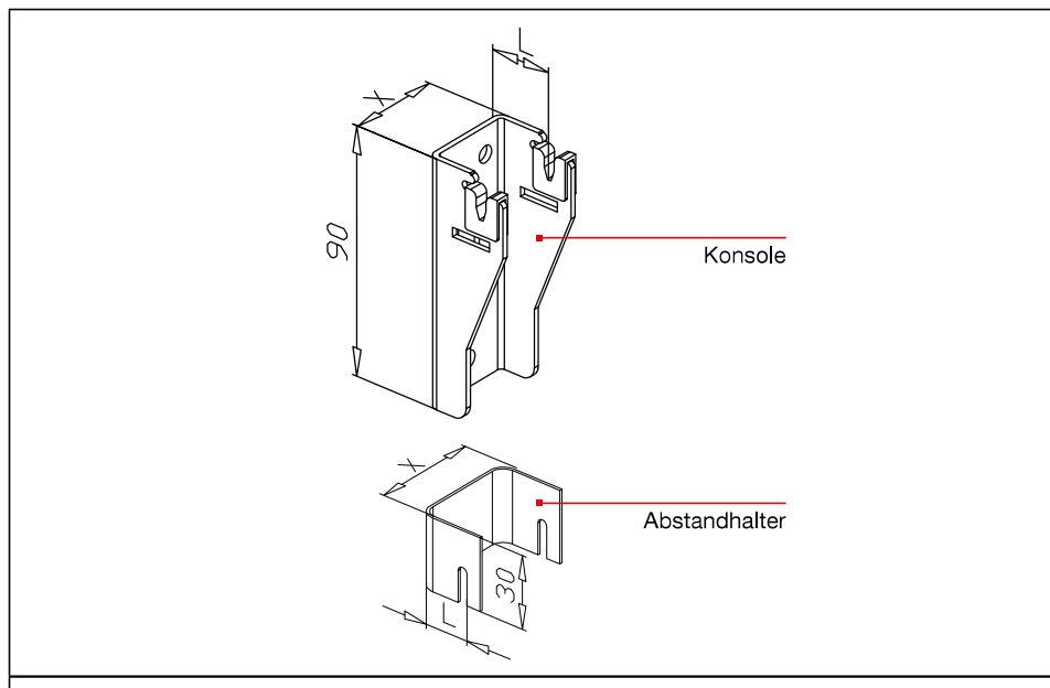
Satz besteht aus 2 Konsolen, 2 Abstandhaltern, 2 Schrauben (8 x 60 mm) und 2 Dübeln (10 mm).
