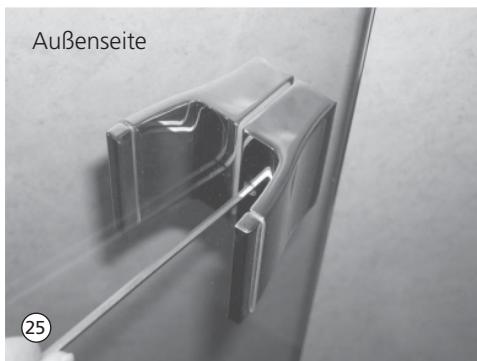
25. Zweite Griffhälfte gemeinsam mit der Griffunterlage von außen über die Befestigungshülse schieben und durch Eindrehen des Gewindestiftes M5 auf Befestigungshülse fixieren. Gewindestift hierbei fest anziehen.
