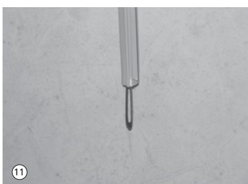
11. Die graue Gelenkdichtung muss beim Montieren so positioniert werden, dass das zweilagige Ende der innenliegenden Verstärkung unten ist.
