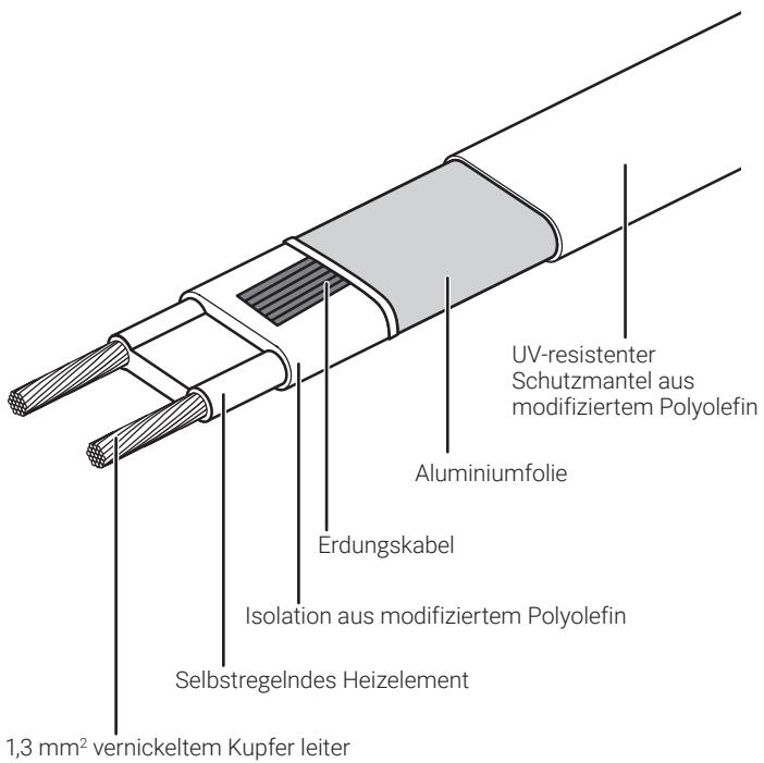
Das selbstregelnde Heizband nVent RAYCHEM BSA wird für Frostschutzanwendungen an industriellen, nicht dampfgespülten Rohrleitungen mit moderater Temperatur eingesetzt. Es kann sowohl für Innen- als auch für Außeninstallationen in Nicht-Ex-Bereichen verwendet werden.
