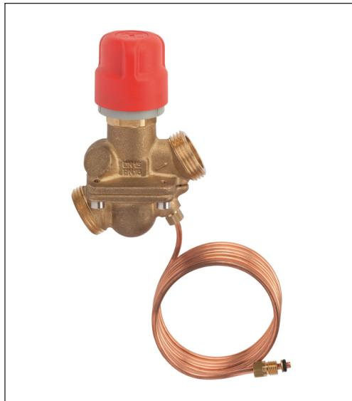
Der AB-PM ist ein kompakter, automatischer Differenzdruckregler, der für den optimalen hydraulischen Abgleich in horizontalen Strängen entwickelt wurde. Er eignet sich für Heizkörper- sowie Fußbodenheizungs- und -kühlanwendungen. Eine differenzdruck-unabhängige Durchflussbegrenzung ist nun gewährleistet.
