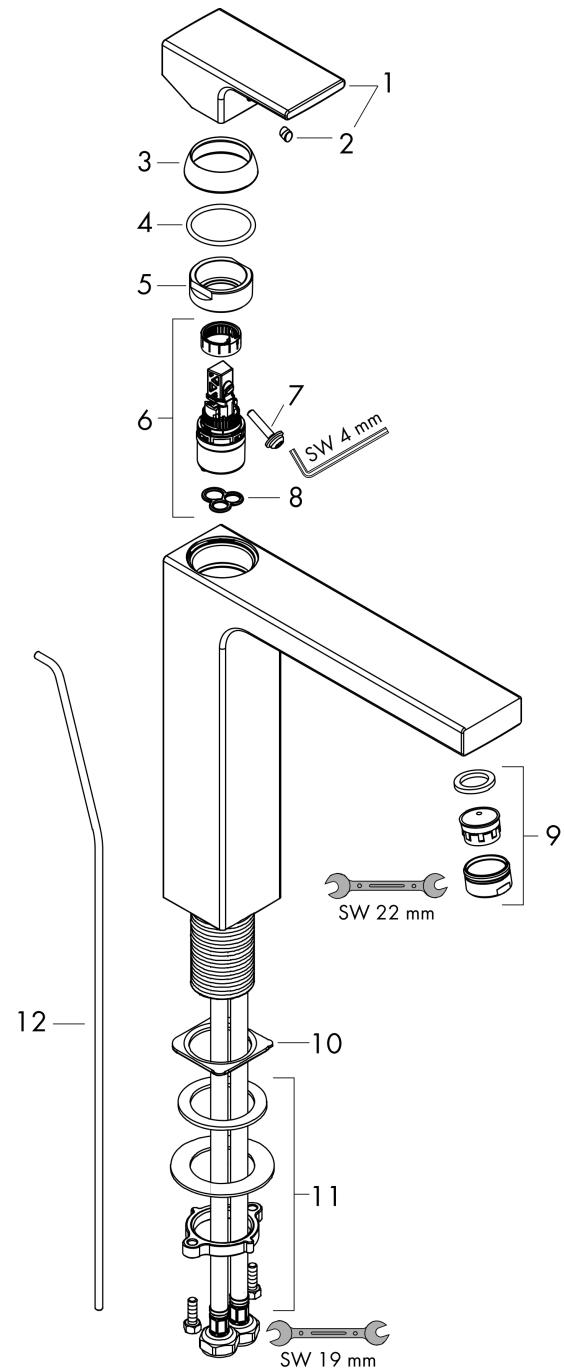
**Vernis Shape****Einhebel-Waschtischmischer 190 mit isolierter Wasserführung und Metall Zugstangen-****Ablaufgarnitur**Oberfläche: **Chrom** Artikelnummer: **71590000**
