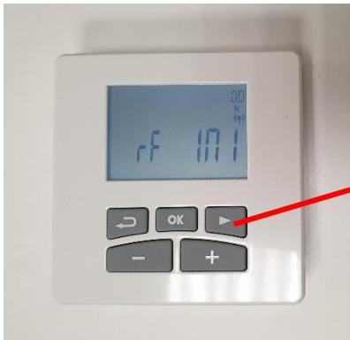
**Schritt 2:** Drücken Sie die Taste (►) auf der Fernbedienung für 5 Sekunden. Nach Ablauf dieser Zeit erscheint "rF INI" auf dem Display der Fernbedienung.
